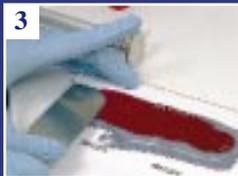
3. Utilice una espátula rígida de metal. Repetidamente extienda el material sobre el block de mezcla, al llevar la espátula hacia arriba se producirá una mezcla altamente homogénea y libre de burbujas.
